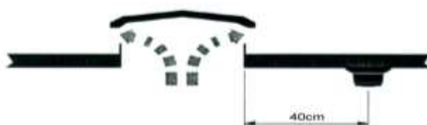
Slika Raspored detektora sa bilateralnom ventilacijom na plafonu
