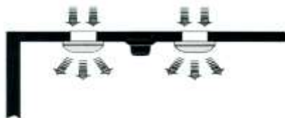
Slika: Pozicija detektora sa vazдушnim otvorima na plafonu
