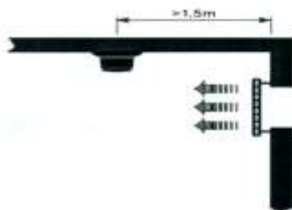
Slika: Pozicija detektora pri bočnom provetravanju
